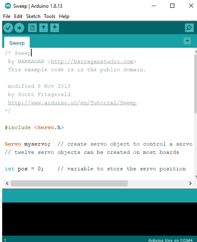
Gambar 1. Contoh tampilan antarmuka Arduino IDE
