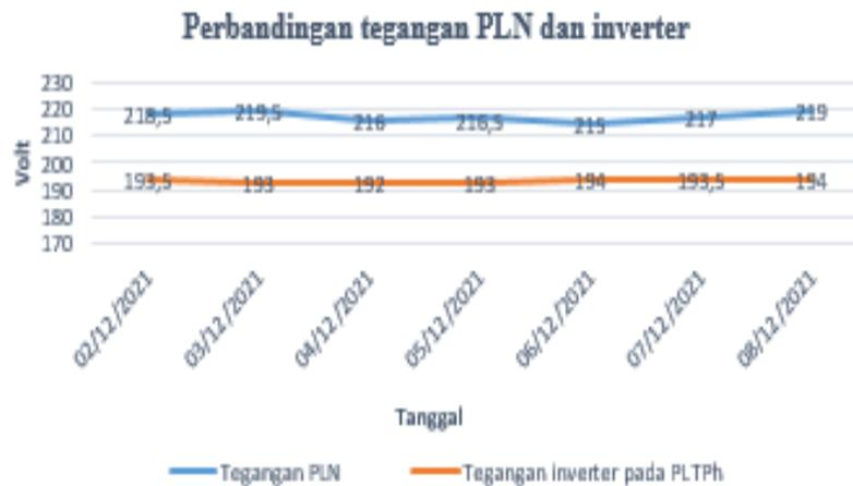
**Gambar 7.** Perbandingan tegangan PLN dan inverter pada PLTPH
