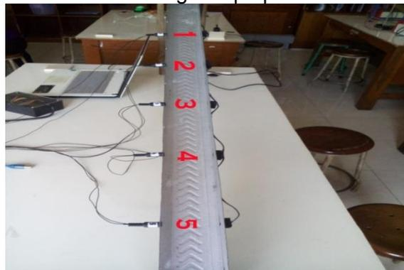
Gambar 3 rangkaian media praktikum gerak lurus berbasis *mikrokontroller*
