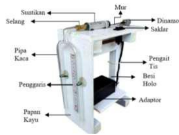
Gambar 1. Alat Praktikum Pembeding Massa Jenis Fluida Statis
