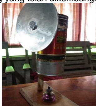
Gambar 1. Alat peraga mesin stirling
