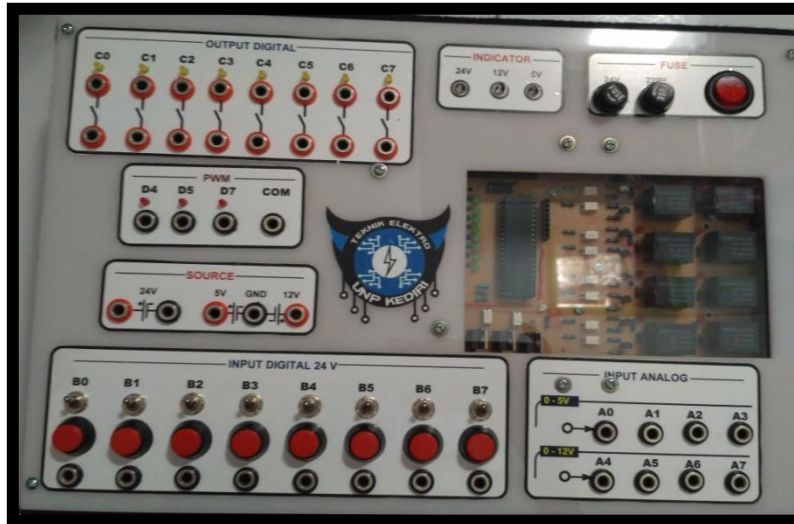
Gambar 5. Tampilan PLC berbasis mikrokontroller Atmega32
