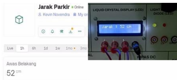
Gambar 4. Hasil pengujian project 2 jarak parkir dengan sensor
