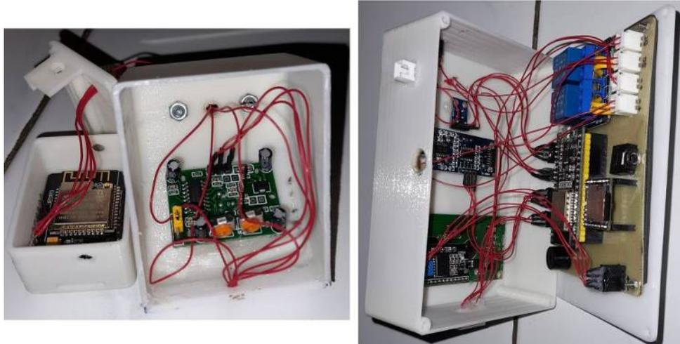
Gambar 3. Pengkabelan alat sistem keamanan rumah
